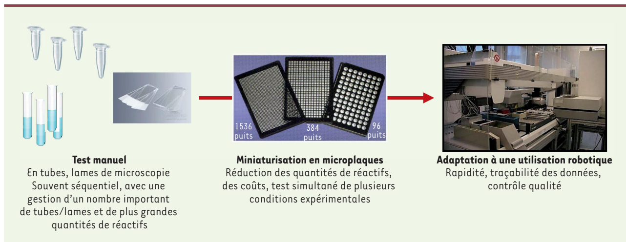
Figure 3. Schéma des étapes de l'adaptation d'un test manuel au format de microplaques (96, 384 ou 1536 puits) pour son exécution itérative par une plate-forme robotisée.
