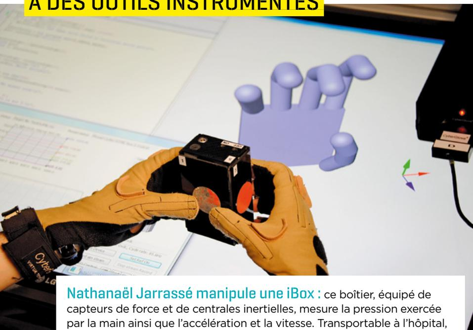
**Nathanaël Jarrassé manipule une iBox :** ce boîtier, équipé de capteurs de force et de centrales inertielles, mesure la pression exercée par la main ainsi que l'accélération et la vitesse. Transportable à l'hôpital, il permet d'évaluer les capacités motrices des membres supérieurs d'une personne à des fins diagnostiques.
