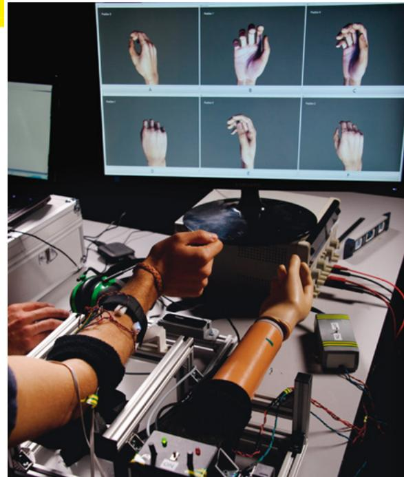
**En retour, la prothèse peut « parler » :** via des vibreurs installés sur son bras valide, le participant reçoit des signaux vibratoires lui indiquant l'orientation de la main robotisée. But de l'expérience : réussir à mettre la prothèse dans une position précise, puis s'assurer qu'elle est bien placée en « ressentant » les informations qu'elle envoie.
