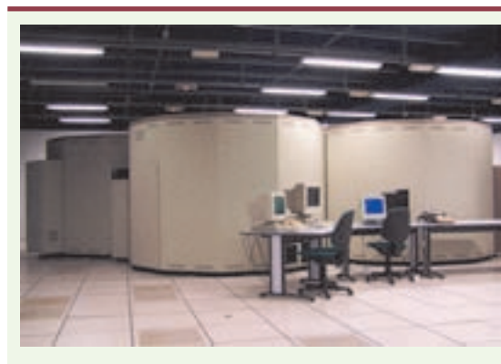
Figure 2. Silos de stockage à grande capacité. Contrairement aux idées reçues, la question du stockage pérenne ne joue qu'un rôle relatif dans la question de la pérennisation de l'information numérique.
